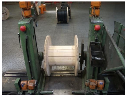
Abb.14: Holz trommel im Aufwickler eingespannt
